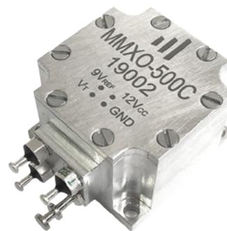
MMXO-500C — комбинация термостатированного генератора MOXO-100 и пятикратного умножителя частоты с буферным выходным усилителем мощности. Благодаря тщательной проработанной схеме умножителя частоты реализован весь шумовой потенциал MOXO-100 на высокой частоте. Приведенный к выходу генераторной части MMXO-500 (к 100 МГц) уровень фазового шума находится на уровне ниже  $-180$  дБн/Гц.
